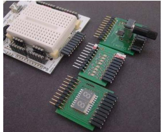
Les **Edu-shields** sont des shields compatibles avec les cartes Arduino. Il y a donc 20 entrées-sorties à disposition, ce qui permet des cartes plus spectaculaires, mais pas nécessairement plus pédagogiques et surtout plus délicates entre les mains d'élèves.
