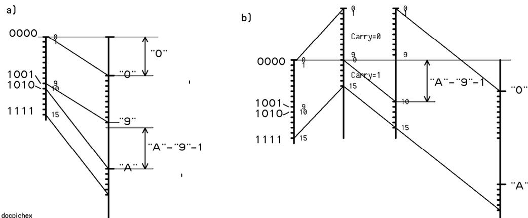
0.95 La solution la plus élégante est décrite dans la partie b) de la figure ci-dessous. On soustrait 9+1 (ajoute -10) pour avoir le Carry qui vaut 1 pour les nombres supérieurs à 10, on corrige et on passe en hexa.
