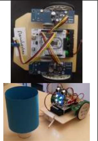
Smofix (*Smart Motor Fixture*) est une carte interface comportant 2 parties séparables qui servent de commande et fixation des moteurs, pour les moteurs recommandés Bo-10 et Bo-07. D'autres moteurs peuvent être commandés, en adaptant leur fixation. La liaison au microcontrôleur se fait à choix avec 3 connecteurs différents grove, 4 pins au pas de 2.54mm ou Micromatch.
